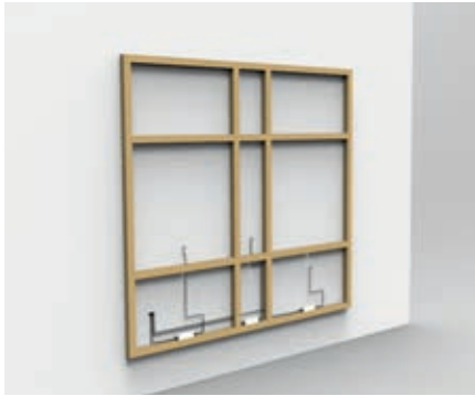
1. Erstellen der Halterungsstruktur mit Vorrichtung zur Versorgung der einzelnen Buchstaben.
