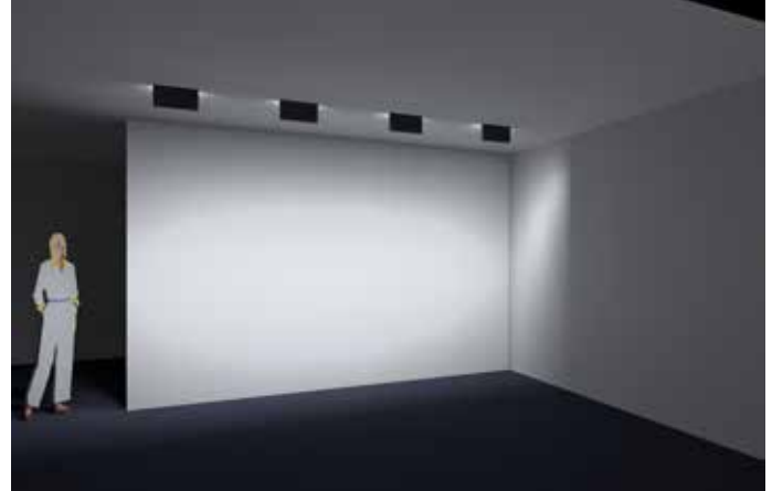
Simulation einer klassischen Wallwasher-Lichtlösung. Ungleichmäßige Wandausleuchtung bei hoher Blendung
