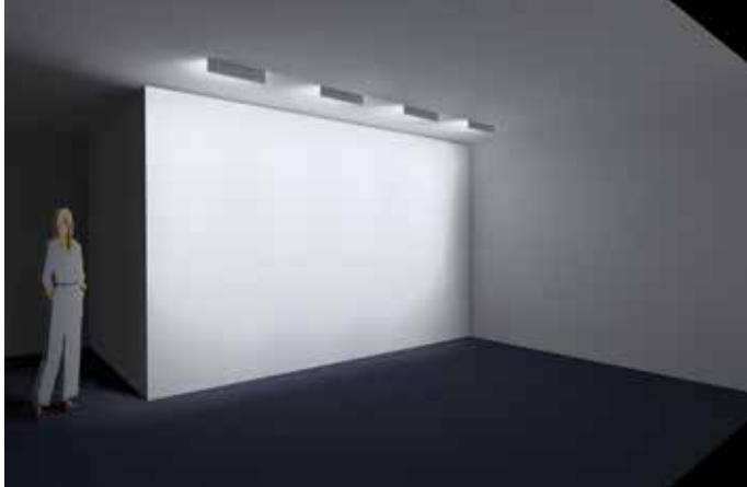
Simulation einer mit RDB längsentblendeter Wallwasher-Reflektoroptik ausgestatteten Leuchte. Gleichmäßige Wandausleuchtung bei geringer Blendung
